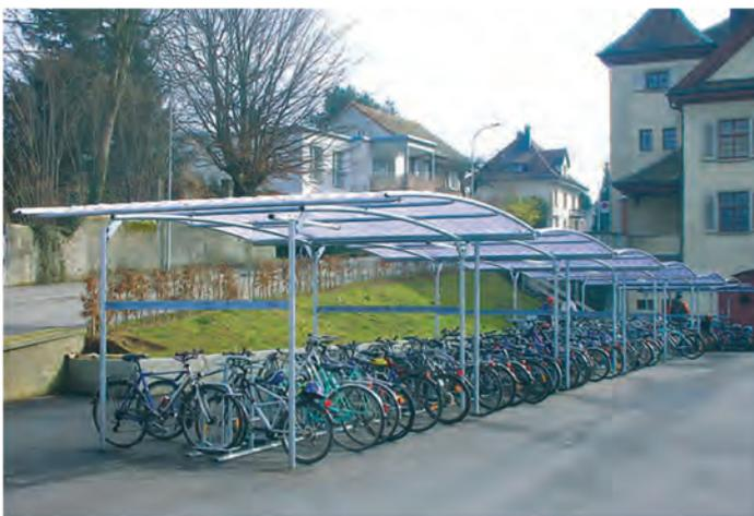
Abris bilatéral, toiture en plaques ondulées translucides de polycarbonate.
